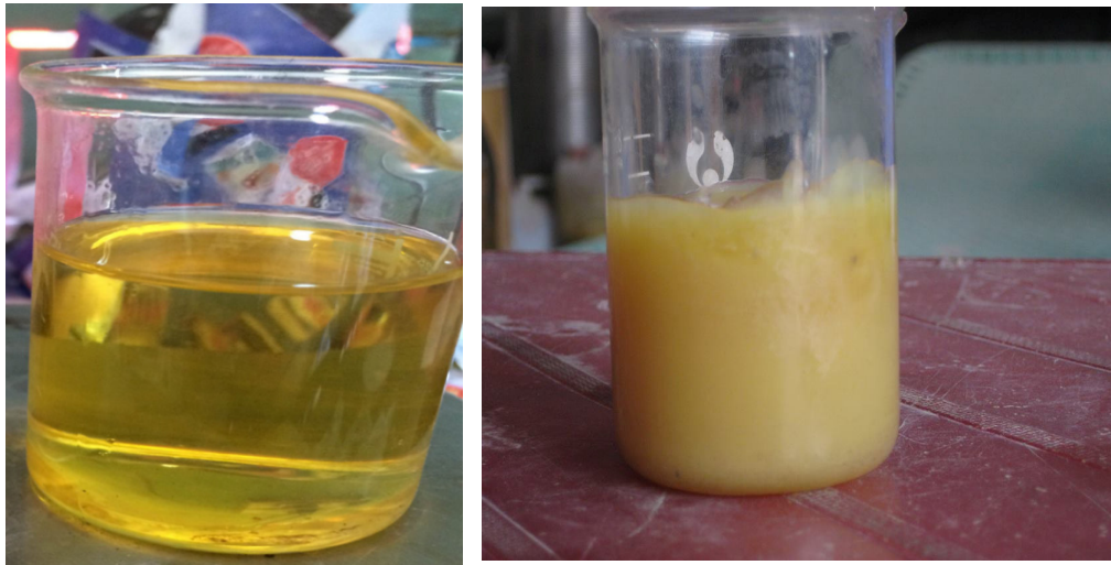
Hình 2: Sản phẩm của quá trình nhiệt phân nhựa HDPE với tốc độ gia nhiệt (a) 1°C/phút và (b) 3°C/phút
