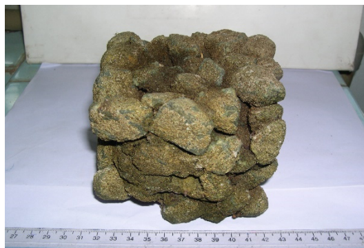
Hình 1: Vật liệu khối bê tông rỗng
