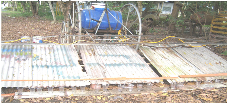
Hình 7: Khảo nghiệm xác định độ cao giàn phun hợp lý
